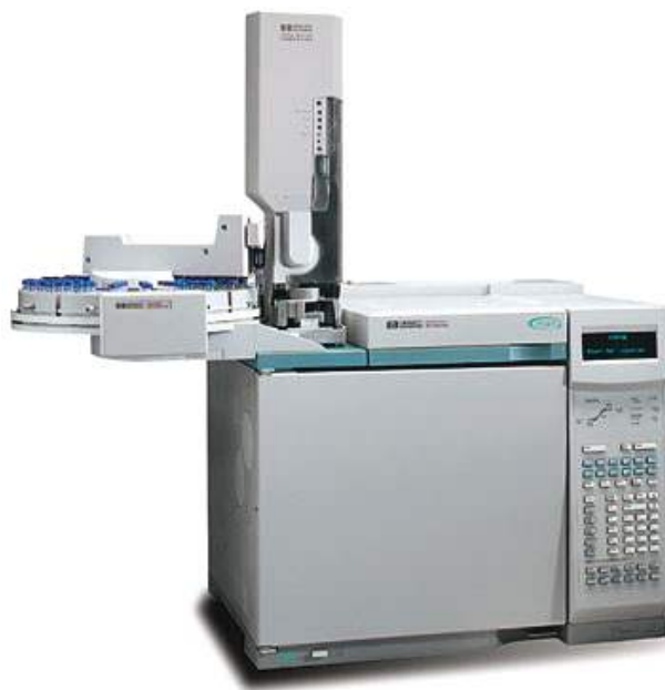
그림 3.2-4 기체크로마토그래피 장치(GC-FID) (6890N, Agilent)
