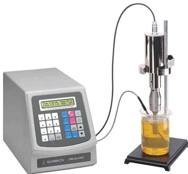
그림 3.2-2 원추형 초음파 추출 장치(VCX-500, Sonics)
