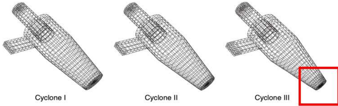
그림 8 CFD Surface mesh of cyclone
